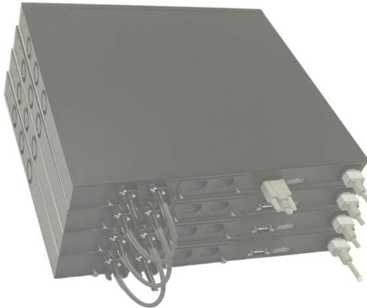
Rysunek 1-3. Łączenie wieży przełączników
